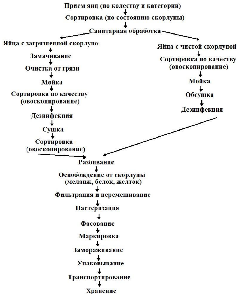
Рис. 1.1. Технологическая схема изготовления яичных мороженых продуктов
