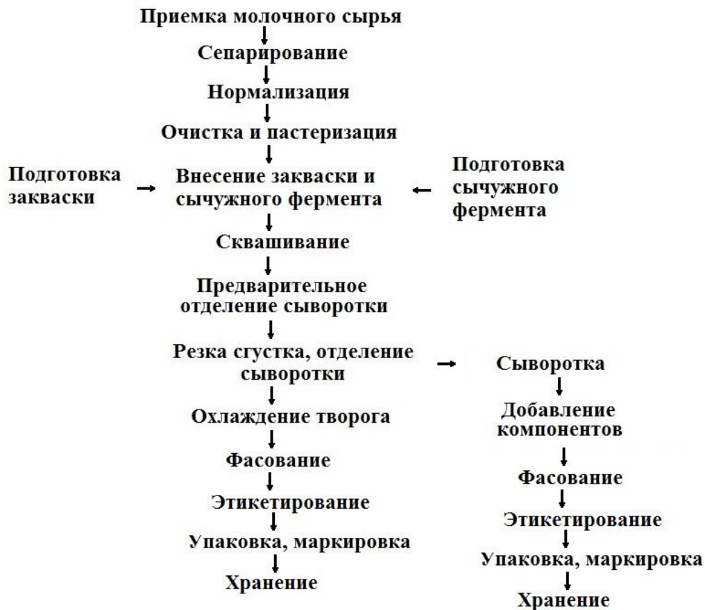
Рисунок 4.1 – Технологическая схема изготовления творога и сыворотки
